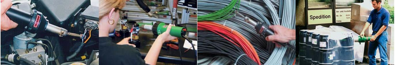
ХОТ ДЖЕТ S с паячной рефлекторной насадкой при усадке муфты с припоем для пайки соединения.
