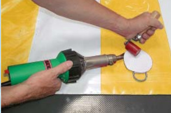
Наварка крепежной накладкой при помощи ТРИАК S.
