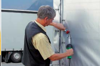
Аппарат ТРИАК PID с щелевой насадкой и прикаточный ролик при ремонте тентового покрытия грузового автомобиля.
