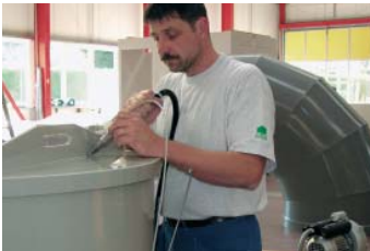
Сварка прутком компактным, высокопроизводительным ручным аппаратом ВЕЛДИНГ ПЭН R.
