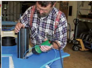
Сварка фасонного изделия ручным аппаратом ТРИАК PID с насадкой быстрой сварки.
